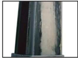
マスト表面のグリスが埃を吸って粘土状に固着し、昇降動作の抵抗になっている。
