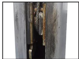
滑車部のグリスが埃を吸って粘土状に変質し、滑車や安全ストッパーの動きを阻害している。
