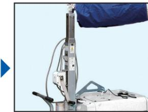
ストッパー A が引っ掛かった状態のままロープを解き、ストッパー B の動作確認に移る。
